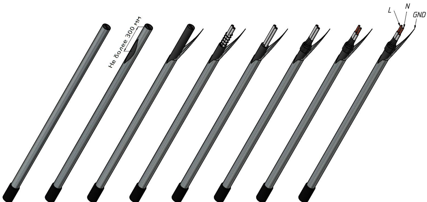
Рисунок 15. Подготовка отрезка ПЭНа к подключению
